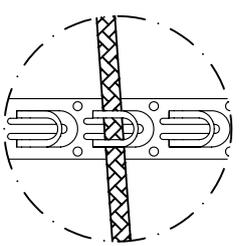
REGGIA METALLICA PER ANCORAGGIO CAVO SCALDANTE
